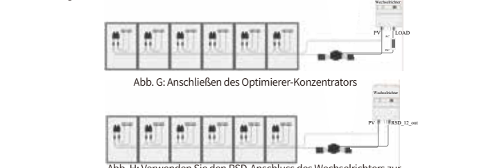
Abb. H: Verwenden Sie den RSD-Anschluss des Wechselrichters zur Stromversorgung des Konzentrators.
